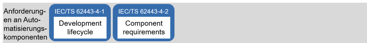
Abbildung 7: IEC 62443 – Teil 4 Anforderungen an Komponenten von Automatisierungssystemen in Anlehnung an [DKE2020]
