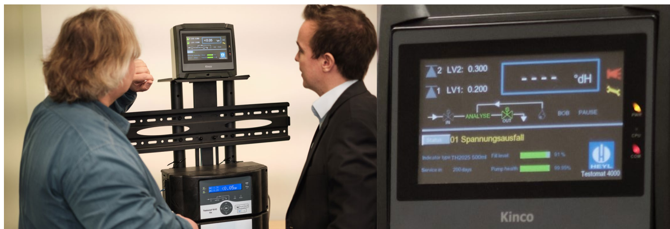
Abbildung 2: Links: Das zur Etablierung digitaler Geschäftsmodelle mit Unterstützung des Kompetenzzentrums weiterentwickelte Wasseranalysegeräte. Rechts: Detailsicht der Leitwartenvisualisierung mit u.a. Anzeige des Gesundheitszustandes der Pumpe und der Dauer bis zum nächsten Service.
