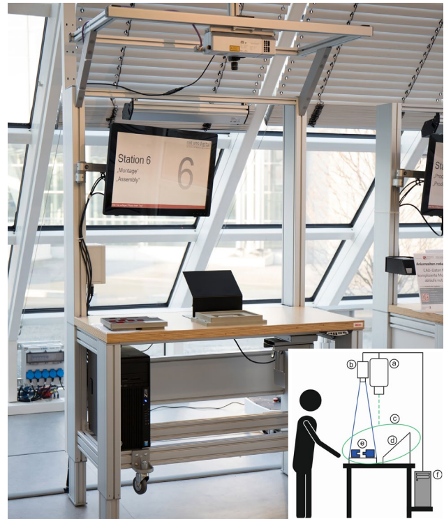
Abbildung 3: Montagestation in der Generalfabrik (links), Schematischer Systemaufbau (rechts)
