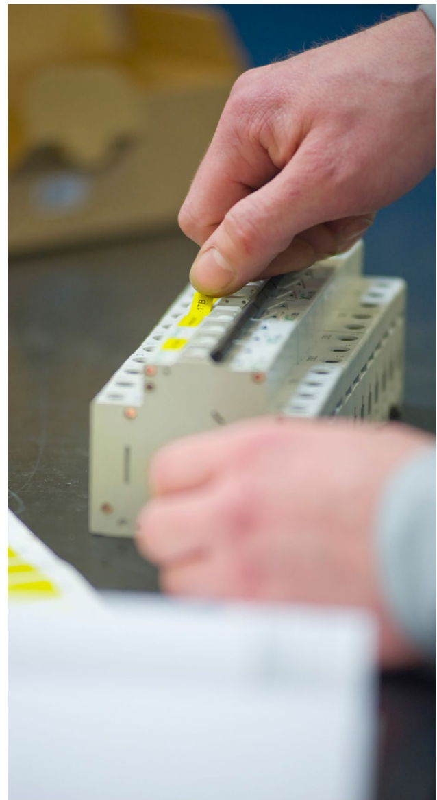
Abbildung 2: Mitarbeiter beim Aufkleben der Betriebsmittelkennzeichnung
