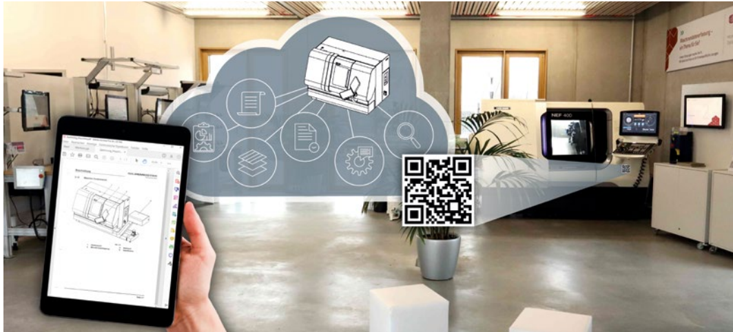
Von jedem mobilen Endgerät abrufbar: Der QR-Code an der Werkzeugmaschine führt zur Verwaltungsschale.
