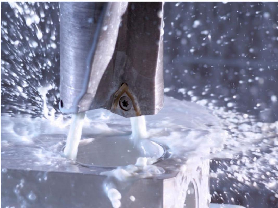
**Bild 1** Wendeschnidplattenbohrer mit angepasster Kühlschmierstoffzufuhr
