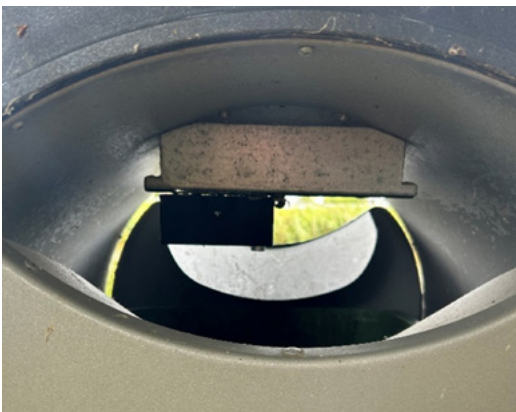
Abbildung 3: Sensor zur Füllstandsmessung in einer Mülltonne
