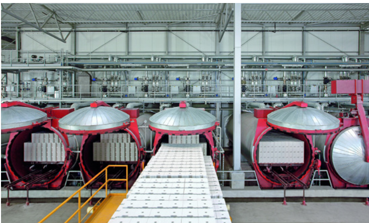
Abbildung 3: Härten der Steine im Autoklav
